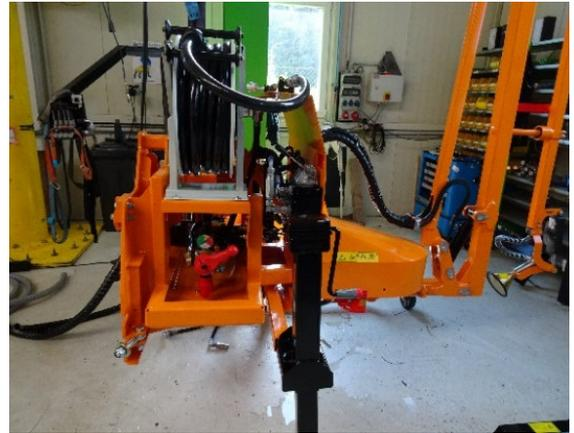
Danach den Gießarm fix mit der Pumpeneinheit verschrauben.
