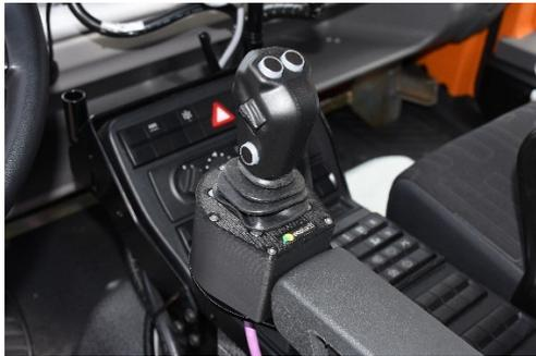
Den gelieferten Joystick mittels der mitgelieferten Halterung im Fahrzeug an der gewünschten Position anbringen.
