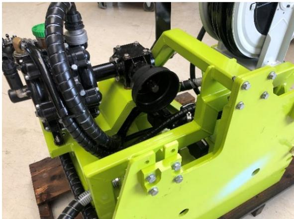
Die Pumpeneinheit ist entweder mit einen Zapfwellenantrieb oder einen Hydraulikmotorantrieb ausgestattet. Je nach Konfiguration muss dieser Antrieb mit dem Fahrzeug verbunden werden.
