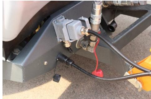
Den Harting Stecker des Verbindungskabels aus der Kabine an die Front des Fahrzeuges verlegen und befestigen.
