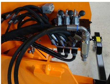
Nun die beiden Hydraulikanschlüsse mit dem Ölmotoranschluss des Fahrzeuges verbinden. Der Ölanschluss des Fahrzeuges muss als Dauerverbrauchen geschaltet werden.
