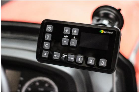
Den Dosierzähler mit der gelieferten Halterung in der Kabine anbringen.
