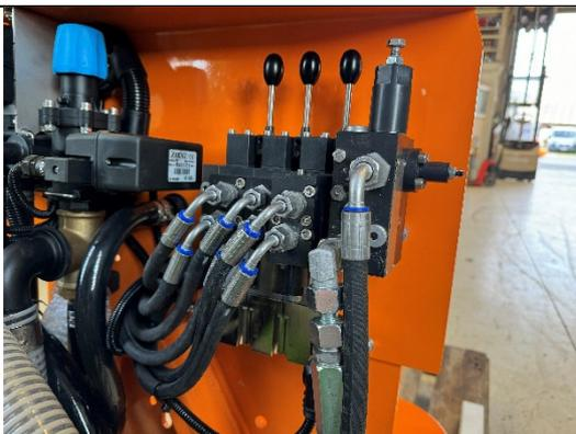
Bei einer Proportional Steuerung kann die Bewegungsgeschwindigkeit der einzelnen Funktionen nicht separat eingestellt werden. Hier ist die Geschwindigkeit ab Werk elektronisch vorprogrammiert und kann lediglich durch die Ölmenge etwas beeinflusst werden.
