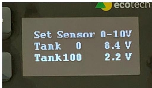
Nach Drücken der „Start“ Taste kann mit den Tasten „AUF/AB“ der Spannungswert für 0%, nach erneutem Drücken der „Start“ Taste der Spannungswert für 100% eingegeben werden. Nochmaliges Drücken der „Start“ Taste speichert die Werte ab. Anm.: Je nach Sensortype kann der 0% oder der 100% Wert der höheren Spannung zugeordnet sein.
