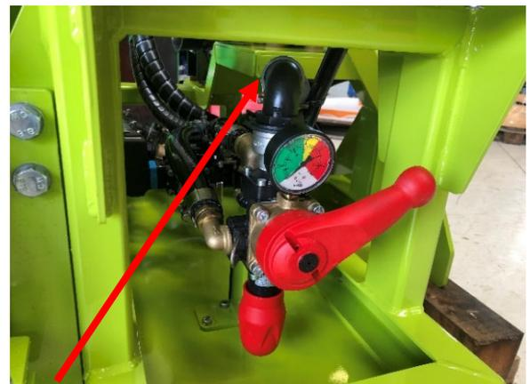
Die Retourleitung muss frei und so hoch wie möglich in den Tank zurückgeführt, und mit der Leitung des Druckreglers verbunden werden.
