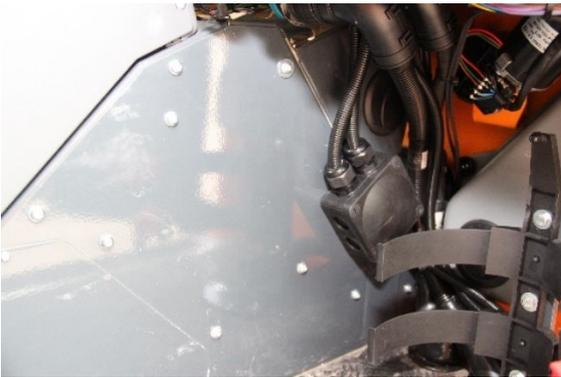
Das gelieferte Verbindungskabel Dosierzähler mit dem 4-poligen Deutschstecker verbinden und die Abzweigdose in der Kabine verlegen.
