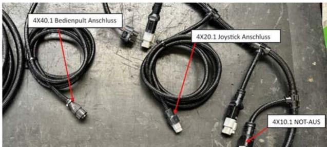
Das gelieferte Verbindungskabel mit dem Joystick (4-poligen Deutschstecker) und dem Bedienpult (4poligen CPC-Stecker) verbinden.
