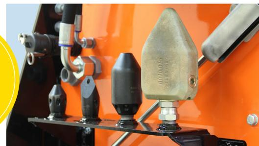
Auf dem Düsenhalter werden alle Düsen sicher am Kanalspülgerät transportiert und sorgfältig aufbewahrt.
