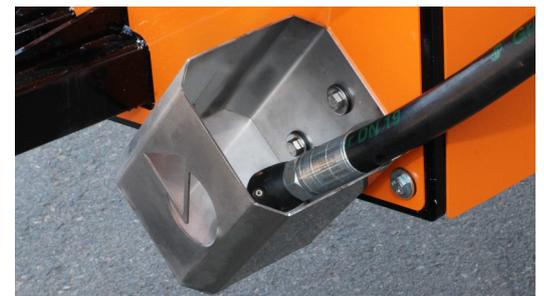
Jene Düse, die am Kanalspülschlauch montiert ist, wird im Düsenköcher abgelegt und transportiert.
