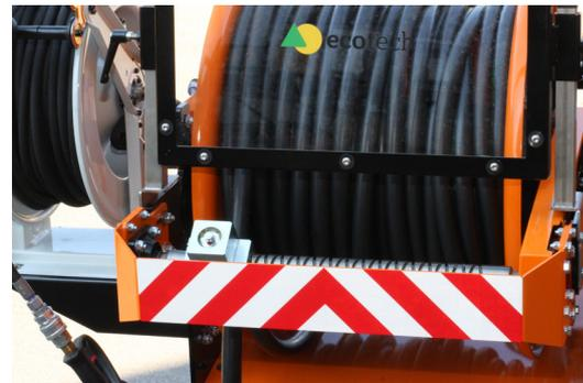
Durch die genormten Sicherheitsmarkierungen wird das Kanalspülgerät für andere Verkehrsteilnehmer sichtbar.
