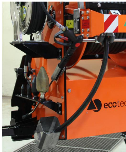
Auf dem Kanalspülgerät sind diverse Halterungen angebracht wie beispielsweise für die Handlanzen oder Düsen.
