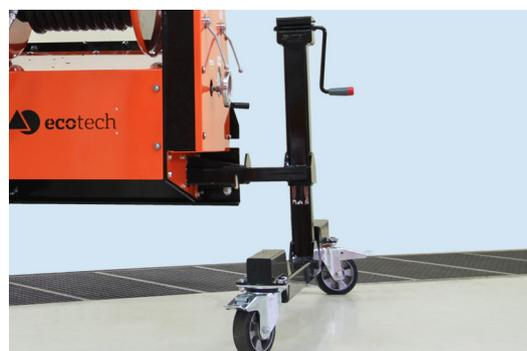
Das Absetzgestell mit robusten Laufrädern erleichtert den An- und Abbau des Kanalspülgerätes und ermöglicht ein müheloses Verschieben zum Abstellplatz.
