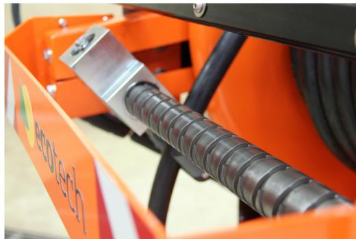
Einführrollen und eine abriebfeste Kreuzspindel ermöglichen regelmäßiges Auf- und Abrollen des Schlauches.
