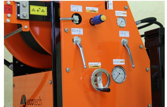
Die gut beschrifteten Bedienelemente des Kanalspülgerätes sind am modular aufgebauten Rahmen integriert.
