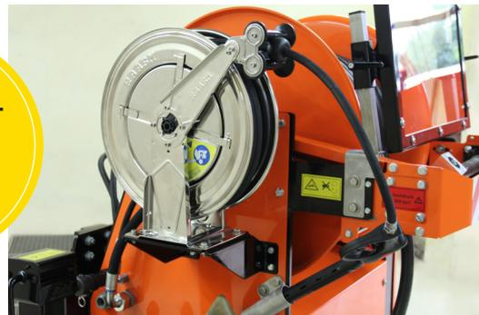
Selbstaufrollende Schlauchtrommel mit knickfreiem und flexiblen Hochdruckschlauch und Handlanze.
