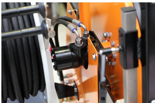
Der leistungsstarke Hydromotor treibt die Schlauchtrommel zum Kanalspülen an.
