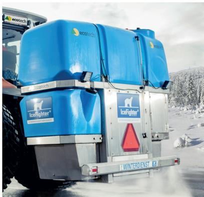
Der ecotech IceFighter® Solesprüher Dreipunktanbau kann im Sommer als Wassertank zum Kanalspülen verwendet werden.
